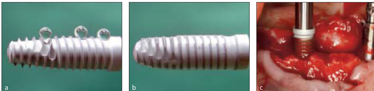
图2a至2c (a) 光化功能前, 种植体表面与三滴3 \mu L的重蒸馏水(共9 \mu L)表现出疏水性, 只有有限的区域与水接触。(b) 光化功能后, 种植体表面产生了超亲水性, 9 \mu L的水(三滴3 \mu L的重蒸馏水)足以扩散并覆盖整个种植体表面。(c) 光化功能后种植体高度亲血; 光化种植体与植入部位接触后典型的口内图像; 注意血液沿着种植体螺纹螺旋上升并到达冠状部分的动态情况。
