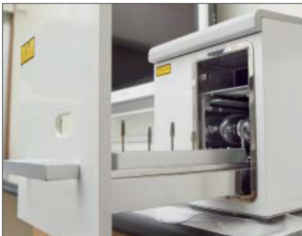
图1a 用于种植牙光化的照射装置（TheraBeam Affinity）。种植体放置在移动平台上，该设备执行自动程序，种植体接受紫外光照射15分钟，通风5分钟。
